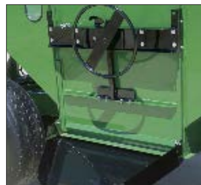
2.8:1 sprocket ratio door opener
