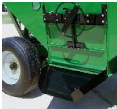
365 & 450 - 2.8:1 sprocket ratio door opener
