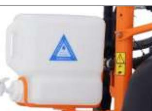
O tanque de água limpa com capacidade de 12 litros oferece mais conforto e proteção ao operador.
