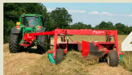
Две узкие полосы размещаются параллельно друг другу благодаря дефлектору валков.
