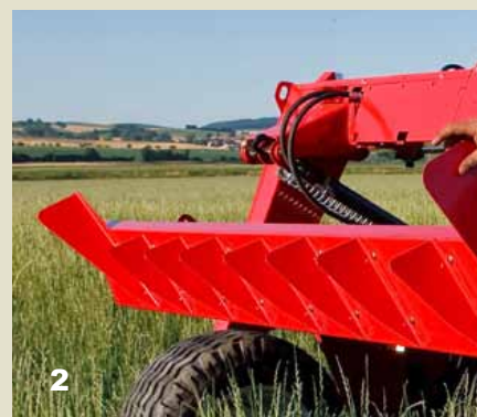
2 Переключение режимов от валкообразования к распространению в расстил происходит очень легко и быстро. Задняя пластина поворачивается на 180° (не требуются инструменты).
