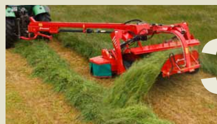
Укладка двух валков в один с валкоукладчиком Kverneland BX для эффективного подбора.
