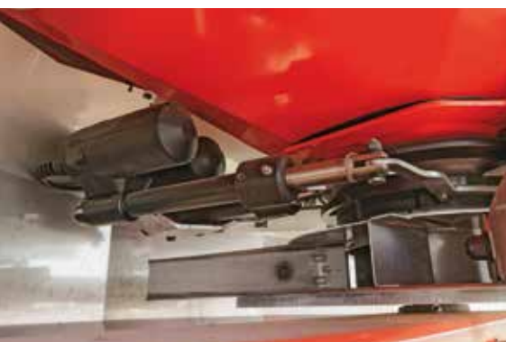
Dva akuatorja na dozirnih enotah, namenjena nadzoru točke izpusta in stopnje trosenja
