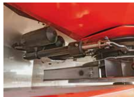
Dva aktuatorja na dozirnih enotah, namenjena nadzoru točke izpusta in stopnje trosenja
