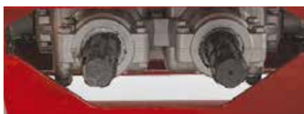
Centralni reduktor z dvojnim priključnim nastavkom za hitre in počasne nastavitve diska
