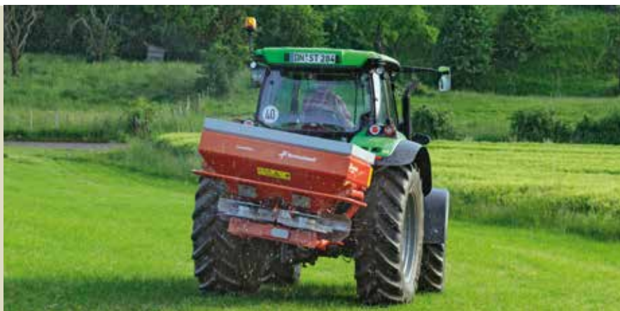
Obmejno trosenje z nagibnim cilindrom
