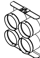
FAB-154-4E.2 (X4) COLLECTEUR 4 SORTIES - BOYAU 2PO (ÉQUIPEMENT) COLLECTOR 4 OUTPUTS - HOSE 2IN (EQUIPMENT)
