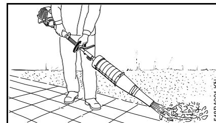
Toujours tenir fermement la machine par les poignées, à deux mains. Prendre la poignée de commande dans la main droite et la poignée du tube dans la main gauche – ceci est également valable pour les gauchers. Entourer fermement les poignées avec les pouces.
