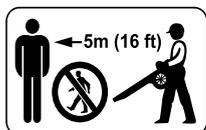
À part l'utilisateur, personne ne doit se trouver dans un rayon de 5 m de la machine en marche – **risque de blessure par des objets projetés !**
