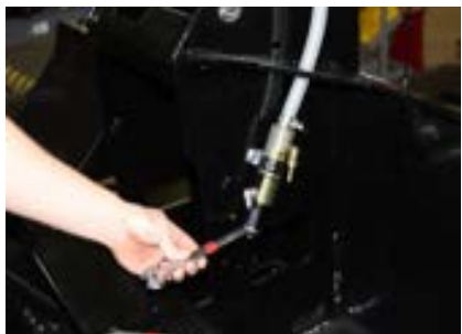
Loosen/tighten jam nut.
