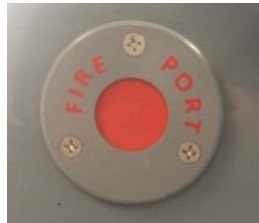
Feuerlöschöffnung auf der Backbordseite der Konsole
