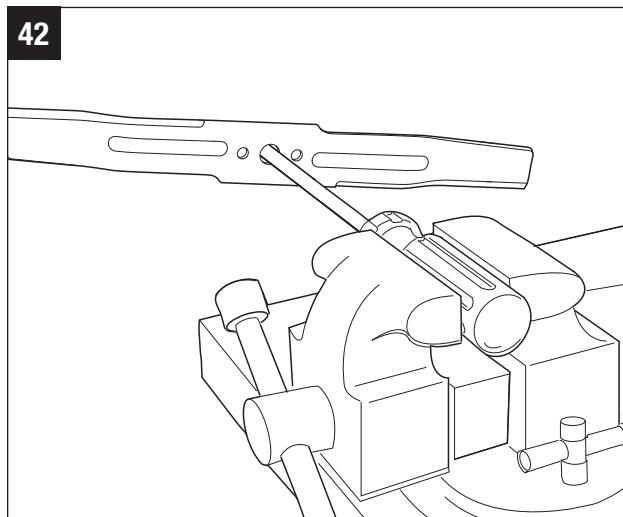
**AVERTISSEMENT :** Une lame mal équilibrée causera des vibrations excessives quand elle tournera à une vitesse élevée. Elle pourrait endommager la tondeuse et se casser, causant éventuellement des blessures.
