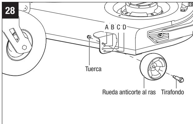
Las ruedas anticorte al ras se ajustan en la Posición B de manera preestablecida en la producción. Están sujetas en la posición correcta por una tuerca y un perno de tope cada una.
