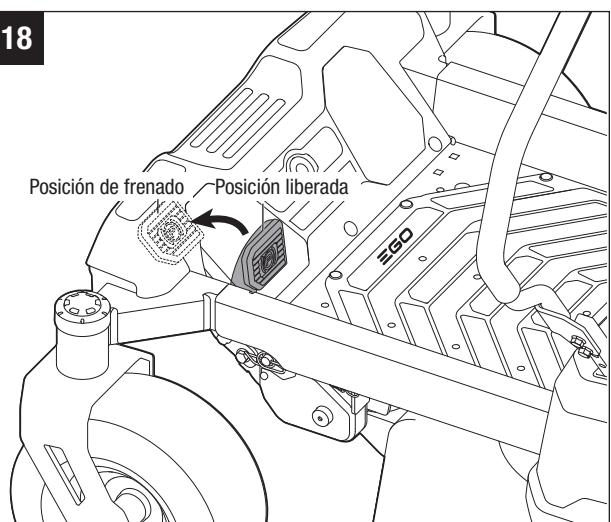
Para liberar el freno de estacionamiento, presione de nuevo una vez más el pedal del freno de estacionamiento; el pedal rebotará hasta la posición liberada.
