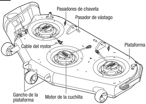
**AVISO:** Reconecte los cables del motor, asegurándose de que el cable izquierdo del motor izquierdo esté conectado al motor izquierdo, el cable del motor central esté conectado al motor central y el cable del motor derecho esté conectado al motor derecho. Los cables están marcados como izquierdo, central y derecho.
