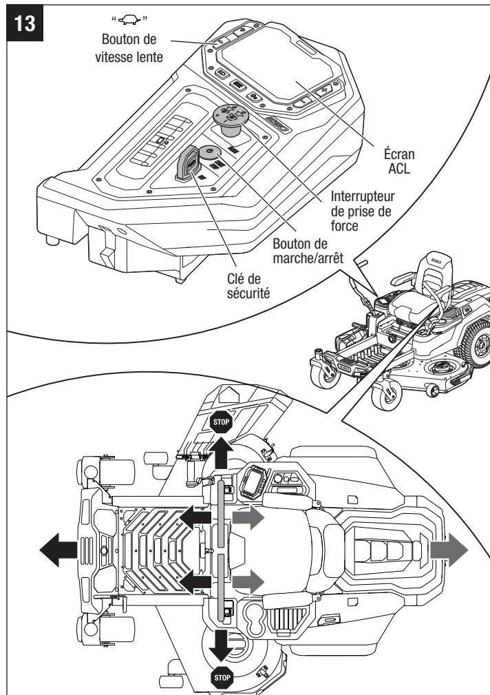
**AVIS :** Si le système de conduite ne s'arrête pas lorsque l'opérateur n'est plus assis sur le siège :
