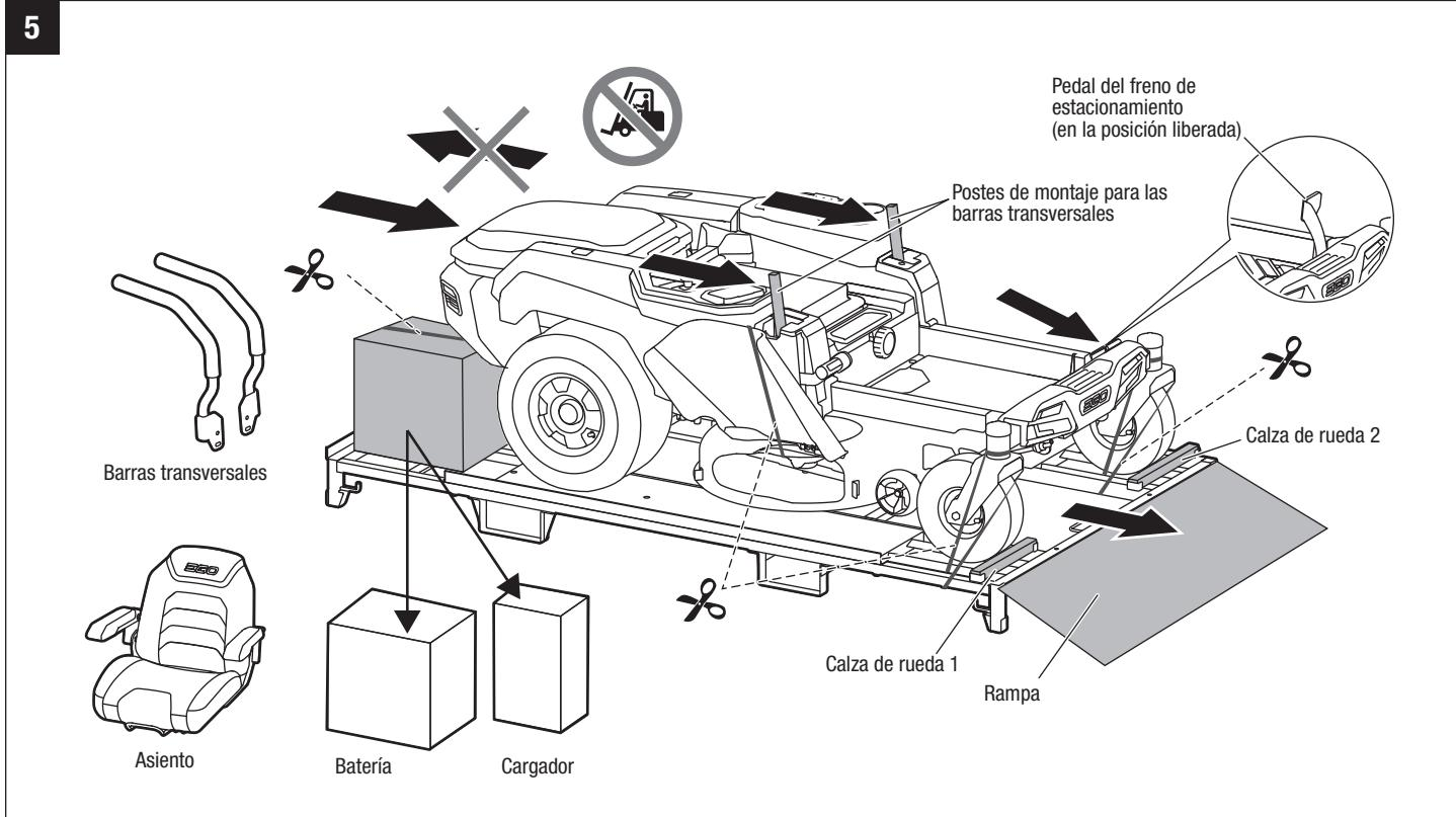
**⚠ PRECAUCIÓN: Objeto pesado. Se requiere empujar en equipo.** Se necesitan al menos dos personas para empujar esta cortadora de césped para separarla del armazón de acero.
