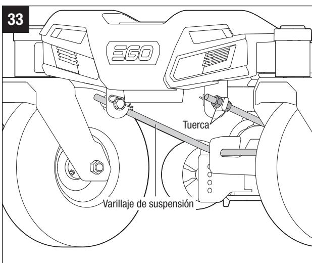
**REMOCIÓN DE LA PLATAFORMA DE LA CORTADORA DE CÉSPED (Fig. 34a y b y c)**
