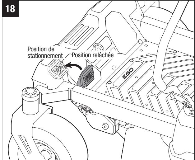
Pour relâcher le frein de stationnement, appuyez une nouvelle fois sur la pédale de frein de stationnement; la pédale rebondira jusqu'à la position relâchée.
