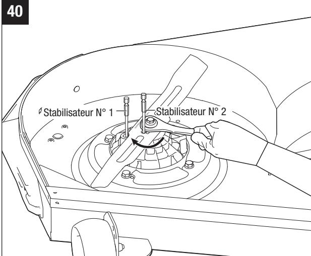
**AVERTISSEMENT :** Une lame usée, fissurée ou endommagée peut se casser, et des morceaux de la lame endommagée peuvent devenir des projectiles dangereux. Inspectez régulièrement la lame, et ne vous servez pas de la tondeuse si la lame est usée ou endommagée.
