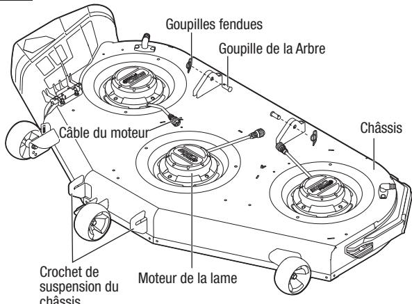
**AVIS :** Reconnectez les câbles du moteur en vous assurant que le câble de gauche du moteur conduit au moteur de gauche, que le câble de moteur intermédiaire conduit au moteur intermédiaire et que le câble de droite du moteur conduit au moteur de droite. La gauche, le milieu et la droite sont marqués sur les câbles.
