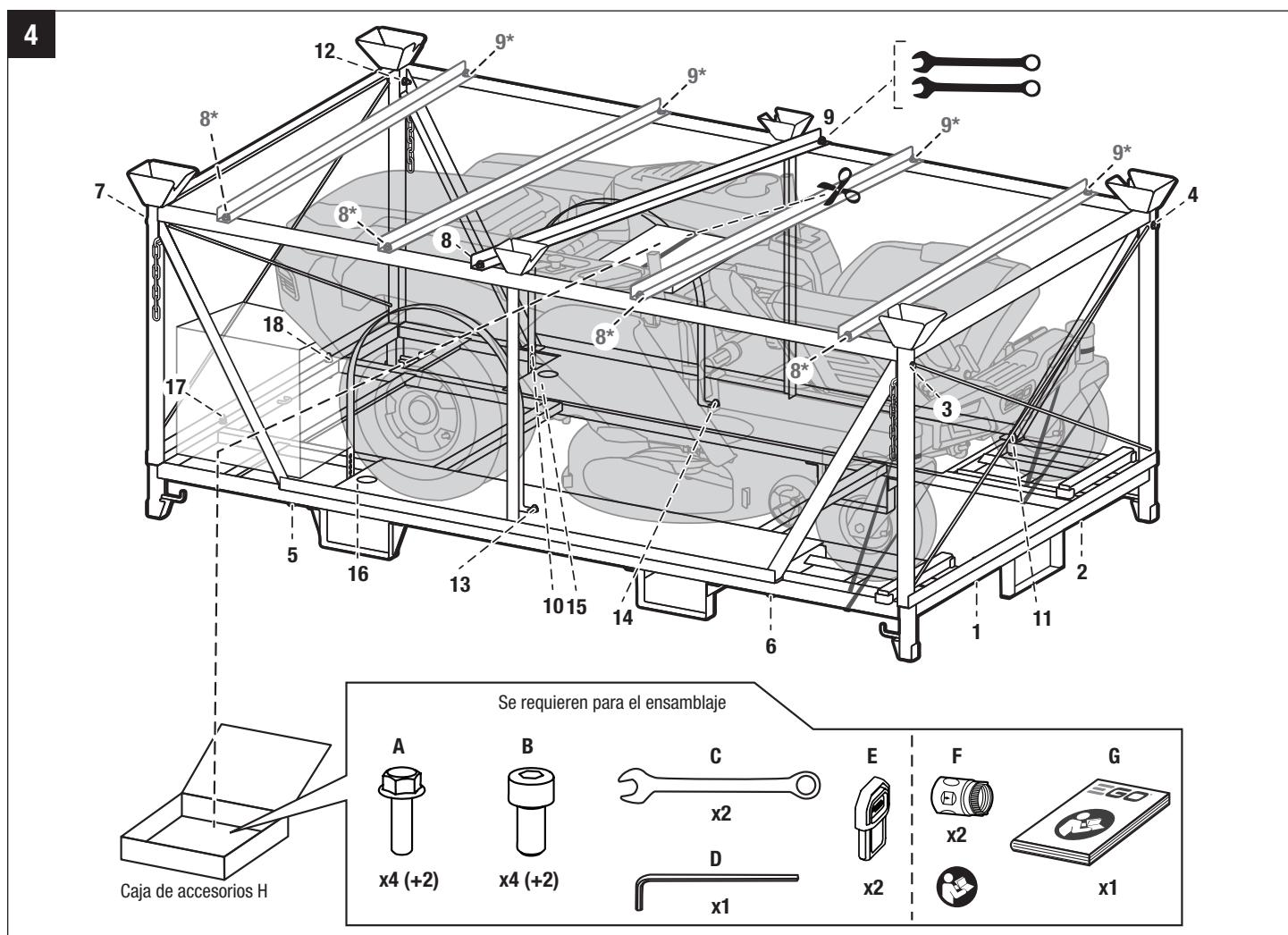
3. Utilice las dos llaves de boca abierta para retirar los 18 pernos que sujetan junto el armazón en el orden numérico que se muestra en la Fig. 4.
