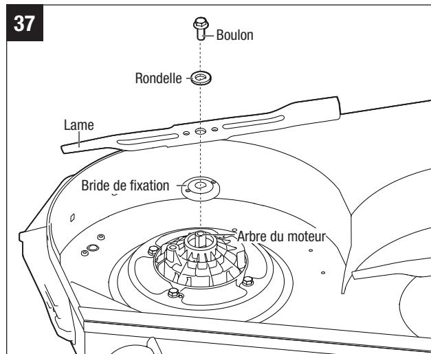
2. Tout en portant toujours des gants de protection, positionnez la lame sur la bride de fixation avec la surface indiquant « **THIS SIDE FACING GRASS** » (Ce côté face à l'herbe) orientée vers l'extérieur (Fig. 38).
