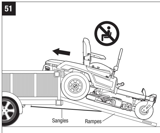
Pour votre sécurité, veillez à ce que l'inclinaison des rampes soit inférieure à 15° dans la mesure du possible.
