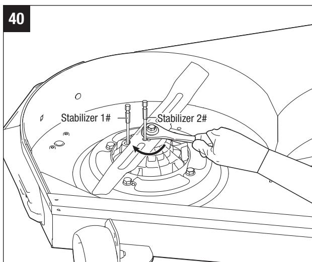
**ADVERTENCIA:** Asegúrese de que la cuchilla esté asentada correctamente y que el perno de la cuchilla esté apretado de acuerdo con las especificaciones de fuerza de torsión indicadas anteriormente. El hecho de no sujetar correctamente la cuchilla podría hacer que esta se afloje y cause posibles lesiones corporales graves.
