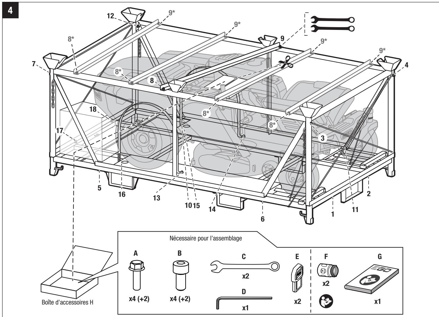
3. Utilisez les deux clés à fourche pour retirer les 18 boulons qui maintiennent le cadre dans l'ordre numérique indiqué dans le tableau ci-dessous Fig. 4.
